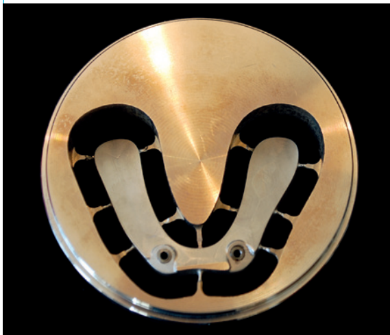
Abb. 1: Aus Metall gefräste Bohrschablone.
