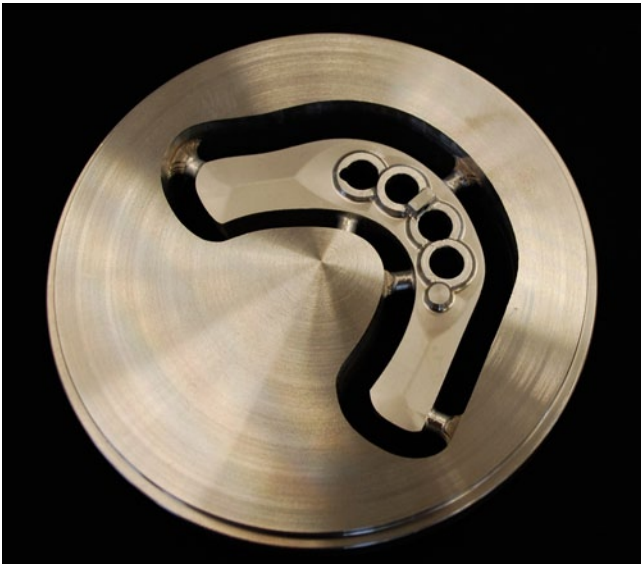
Abb. 1 ◀ Ronde nach Fräsung der Schablone
